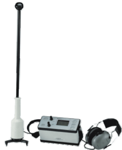
Figure 237: Digiphone type shock wave receiver (Sébaréseaux)
